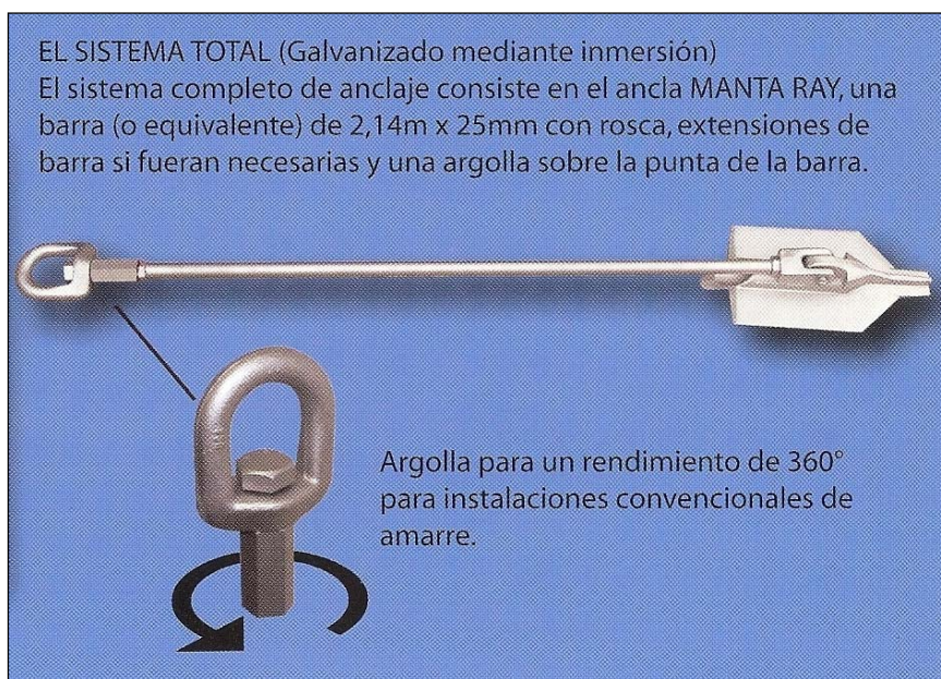
Figura 7. Manta Ray Fondeo ecológico sobre lecho arenoso.
