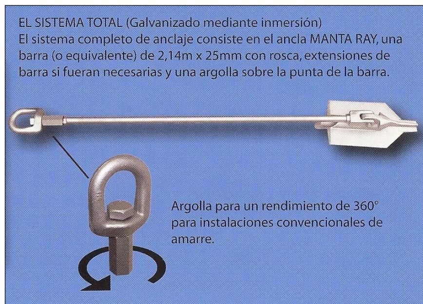
Figura 5. Manta Ray Fondeo ecológico sobre lecho arenoso.
